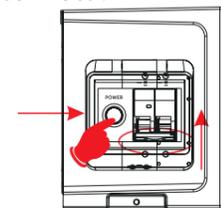
Arranque autógeno: pulse el botón POWER y manténgalo pulsado durante 20 segundos. Suelte el botón cuando los cuatro indicadores SOC parpadeen alternativamente en azul. Sin embargo, no recomendamos el uso del arranque autógeno, ya que puede hacer que el puerto se cargue, provocando una descarga eléctrica. Si las baterías no se han utilizado durante más de 9 meses, deben cargarse al menos hasta alcanzar un SOC del 50 % cada vez.
